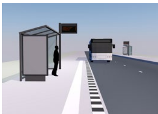
Afbeelding 41. Gewone halte met DRIS halverwege de halte 3D view
