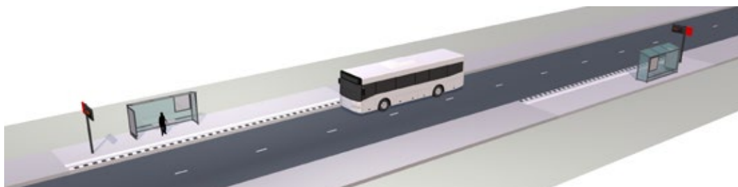
Afbeelding 40. HOV-halte met DRIS op de kop van de halte 3D view
