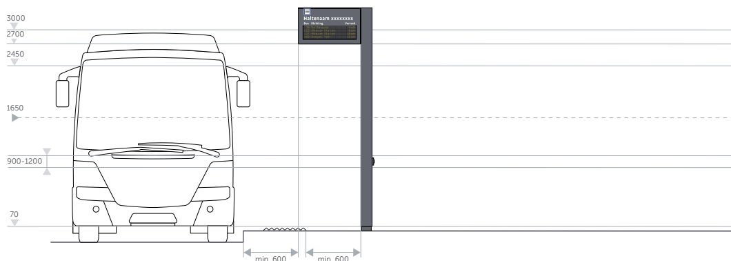
Afbeelding 27. Maatvoering DRIS display op perron
