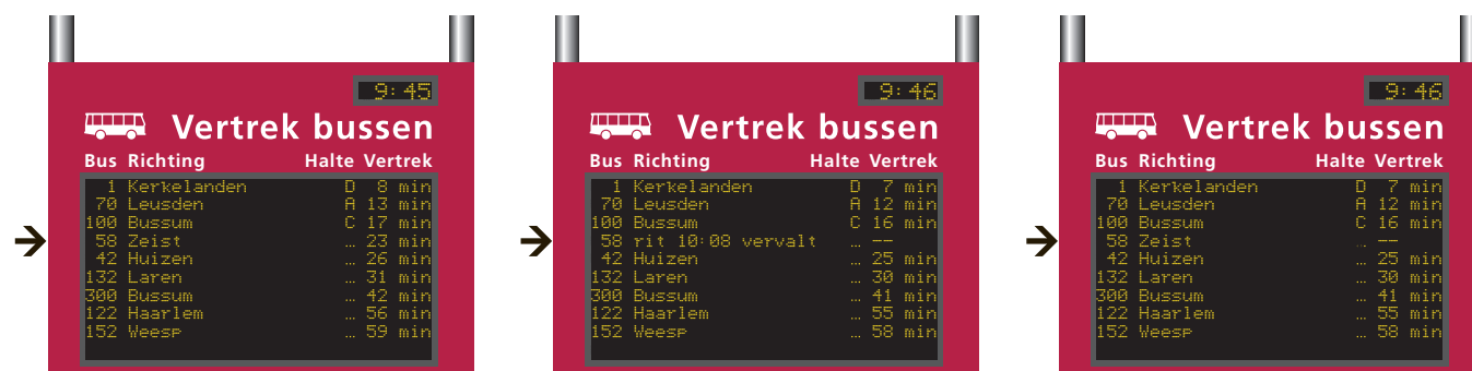
Afbeelding 11 Opeenvolgende schermen (van links naar rechts) waarbij bus 58 naar Zeist komt te vervallen; De mededeling 'rit <hh:mm> vervalt' alterneert met richting, op de plek van de minuten komt '--' te staan en de tekst 'min' vervalt
