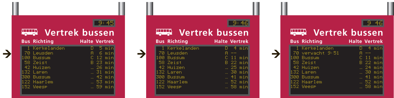
Afbeelding 12 Opeenvolgende schermen (van links naar rechts) waarbij bus 70 naar Leusden status 'Unknown' krijgt; Alternierend met de richting wordt tekst 'verwacht <hh:mm>' weergegeven. Op de positie van de t.t.v. wordt nu '--' weergegeven. De tekst 'min' komt te vervallen.
