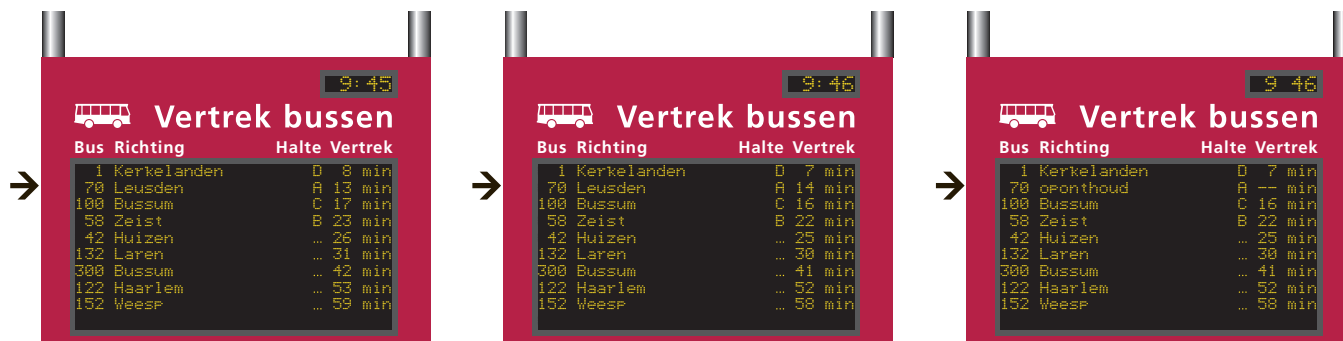
Afbeelding 7 Ritgebonden mededeling op ritregel van de betreffende bus. Opeenvolgende schermen (van links naar rechts) waarbij de richting alterneert met 'oponthoud'.
