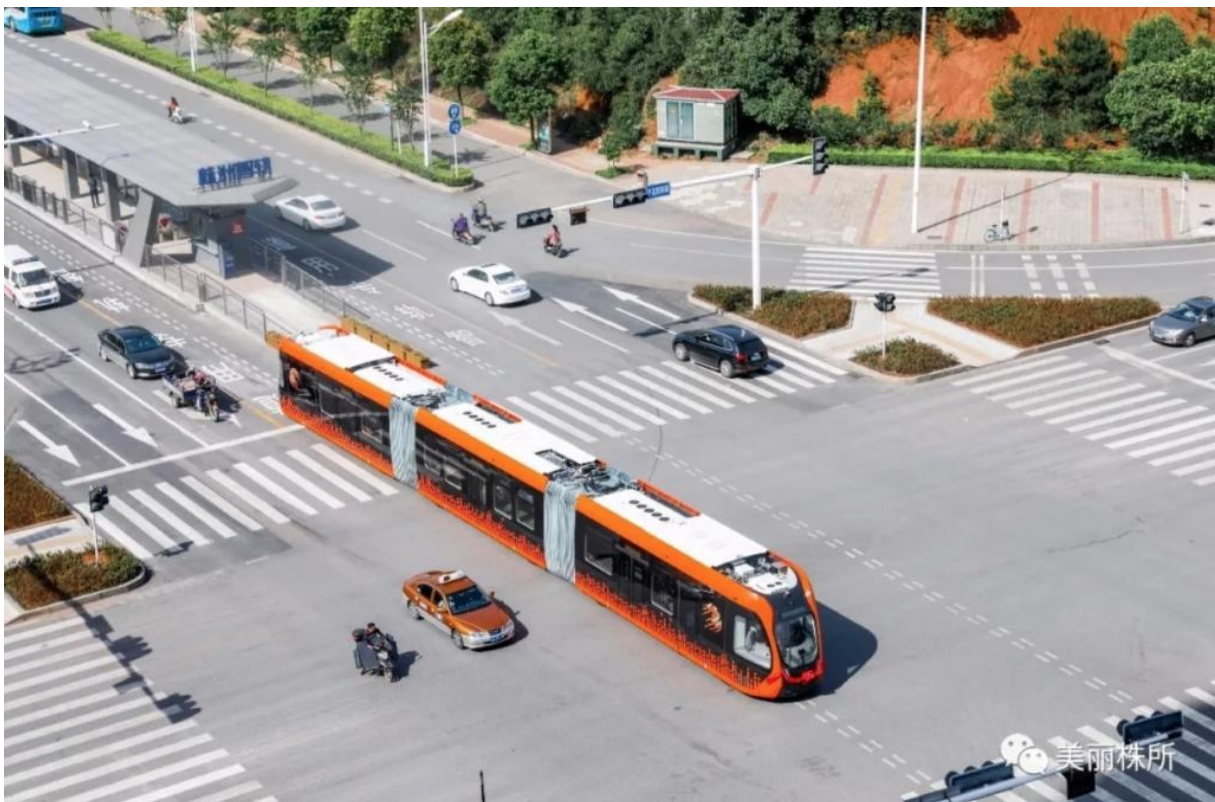
Figuur 4. De autonome “bus-tram” in de stad Yibin in China, rijdend op de weg maar door een specifieke “track” (een geleverde lijn) te volgen (Buch, 2023).
